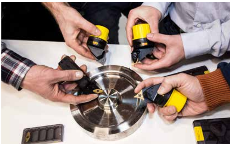
Metoden PrimeTurning™ gör det möjligt att svarva i alla riktningar, vilket löser ett problem som har sysselsatt tillverkningsindustrin i årtal.
