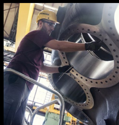
Dykfräsning vid bearbetning av gasturbinhöljen minskar kundens bearbetningstid, kostnader och miljöpåverkan.
