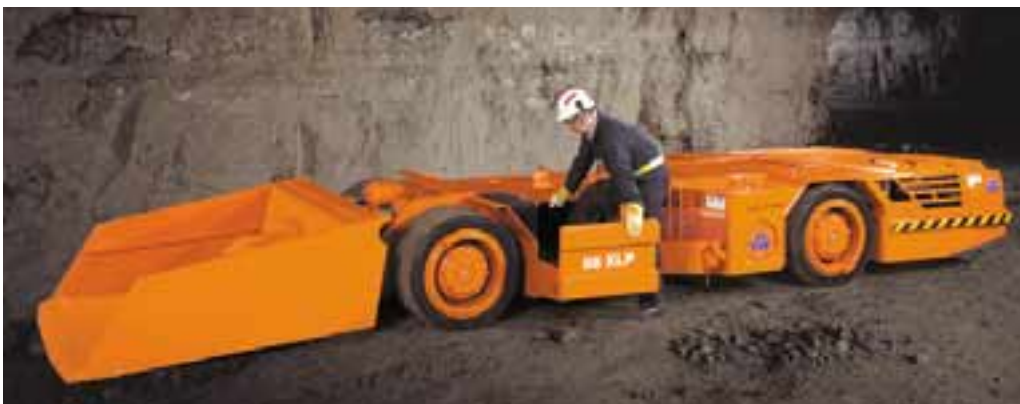
Sandvik Mining and Constructions unika lågprofilastare är inte högre än 88 cm.
