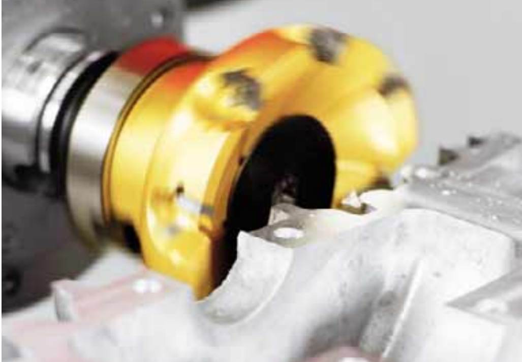
CoroMill Century – en ny fräs för höghastighetsbearbetning av aluminium.
