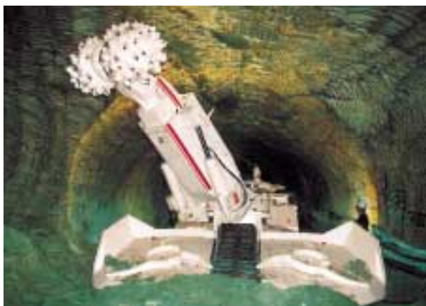
VA-Eimco är specialiserat på produkter för brytning av kol och andra lösa mineraler samt fräsande tunnelbrytning.
