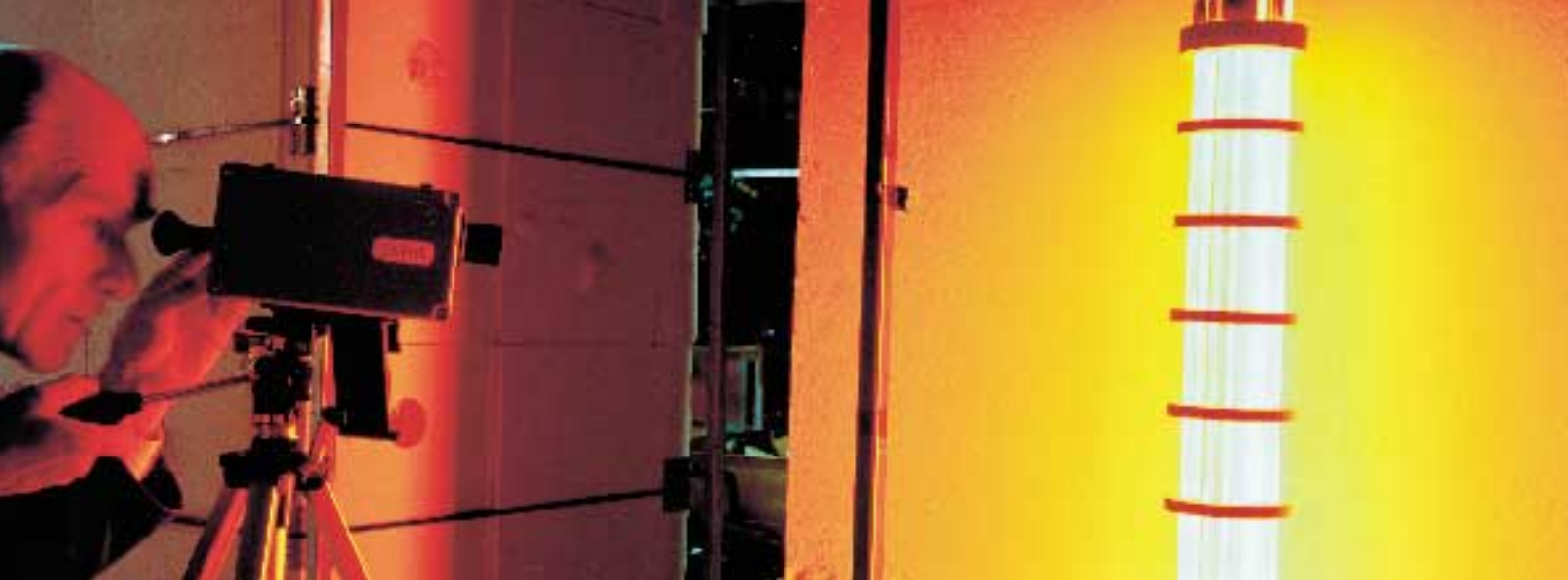
Utveckling av strålningsrörselement för industriugnar vid Kanthals Teknikcentrum i Hallstahammar.
