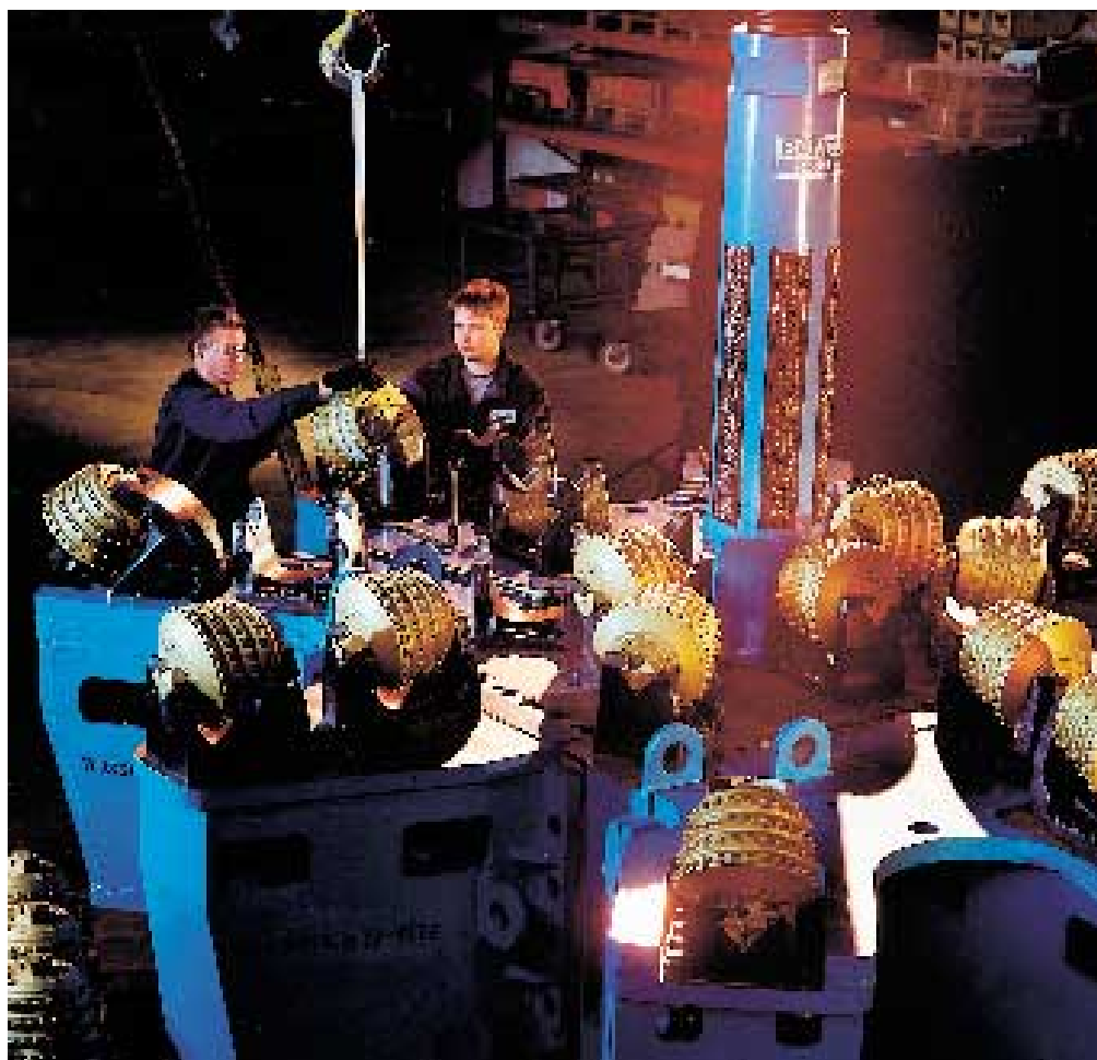
Nya stigortsborrhuvuden från Sandvik Tamrock har inneburit effektivare och lönsammare borrning för kunderna.
