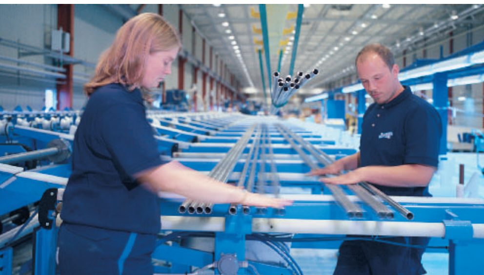
Den nya produktionslinjen för värmeväxlarrör som färdigställdes i Sandviken under året innebär avsevärt förkortad tillverknings tid.
