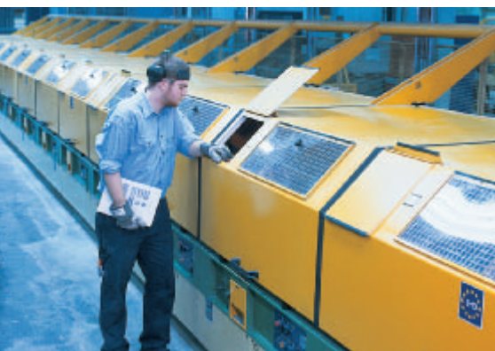
En ny torrdragmaskin förbättrade produktiviteten vid Kanthals anläggningar i Hallstahammar.
