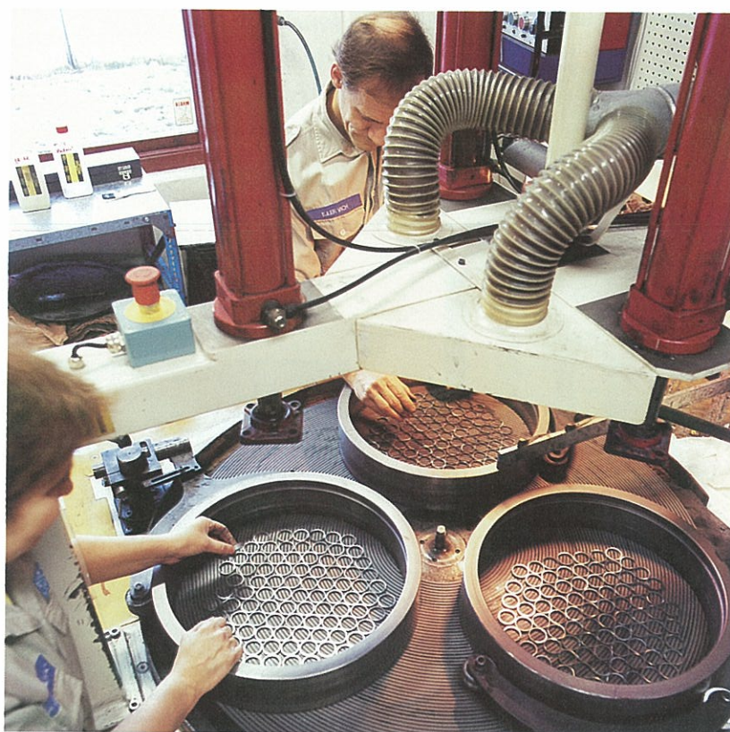
Tätningsskivor för t ex dränkbara vattenpumpar tillverkas vid Sandvik Hard Materials fabrik i Danmark.
