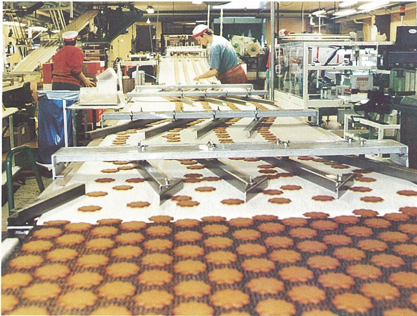
Annas Pepparkakor producerar 1 600 ton kakor årligen på ändlösa stålband från Sandvik Process Systems.
