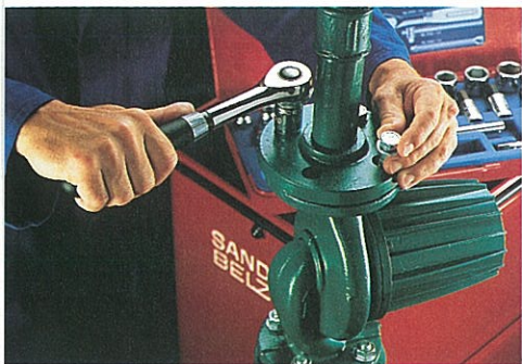
Ett nytt ergonomiskt utformat spärrnyckelhandtag för hylsor introducerades under 1995.
