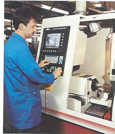
Hårdmetallämnen slipas till en unik skärgeometri i CNC-styrda fleraxliga maskiner.
