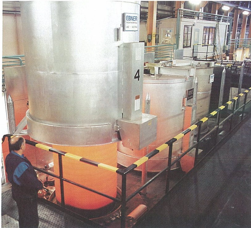
Nya klockugnar fördubblar kapaciteten för glödning av stålband som används för tillverkning av t ex rakblad och knivar.
