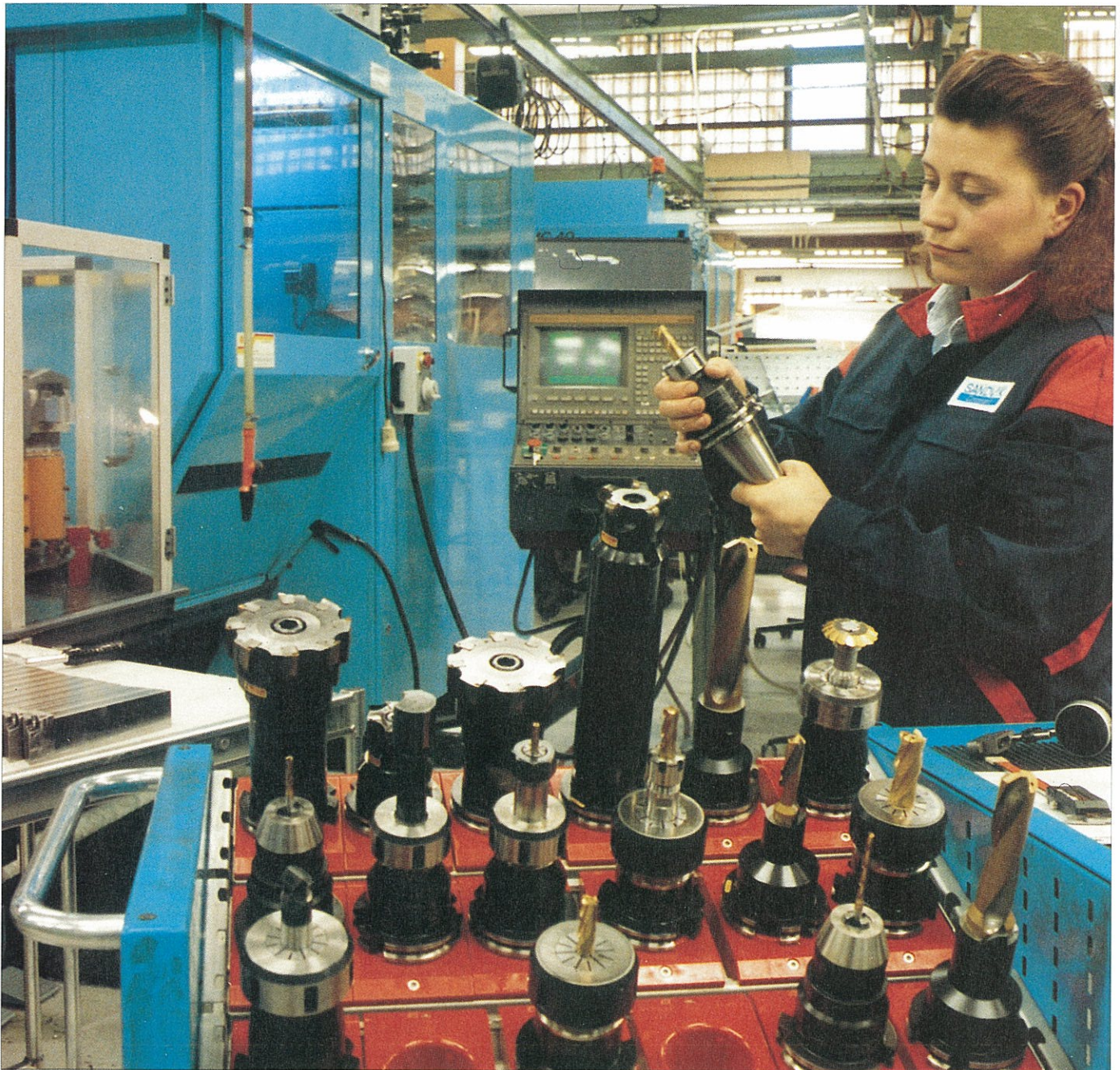
Böret Lindblom vid Sandvik Coromants produktionsanläggning i Sandviken. I en modern fleroperationsmaskin används ungefär lika många hårdmetall- som snabbstålsverktyg.
