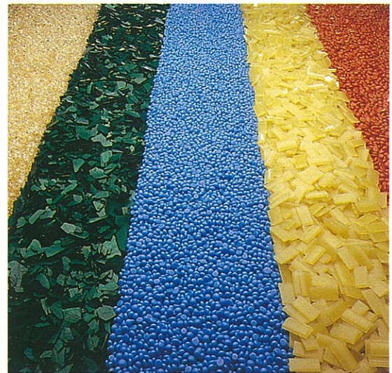
I Sandviks bandkylarsystem omvandlas smält material, t ex svavel, vaxer och hartser, till pastiller, flingor, strimlor och granulat.
