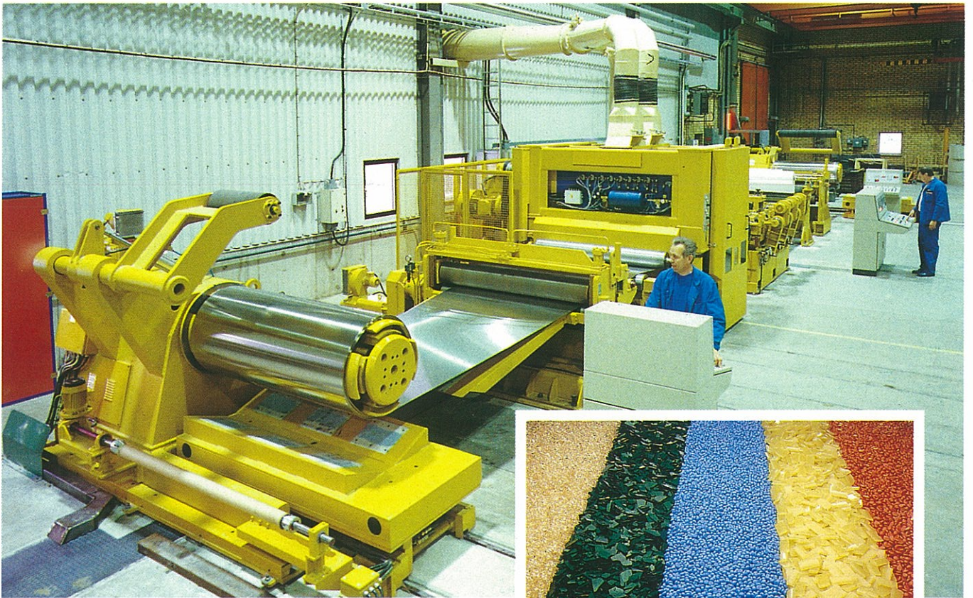
Vid anläggningarna i Sandviken har installerats en ny ytbehandlingslinje för breda stålband.
