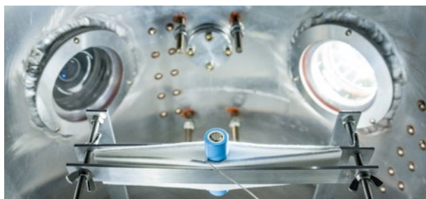
En ARC-kalorimeter från Akkurate för testning av batterier. Den kan användas för att mäta värmekapacitet, termisk stabilitet i cellen eller värmealstring under användning.
